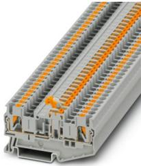
Morsetto con sezionatore a coltello, tensione nominale: 400 V, corrente nominale: 16 A, tipo di connessione: Connessione Push-in, Sezione di dimensionamento: 2,5 mm<sup>2</sup>, sezione: 0,14 mm<sup>2</sup> - 4 mm<sup>2</sup>, montaggio: NS 35/7,5, NS 35/15, colore: grigio
