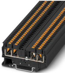
Morsetti per schermatura, tensione nominale: 48 V, tipo di connessione: Connessione Push-in, Sezione di dimensionamento: 2,5 mm<sup>2</sup>, sezione: 0,14 mm<sup>2</sup> - 4 mm<sup>2</sup>, tipo di montaggio: NS 35/7,5, NS 35/15, colore: nero
