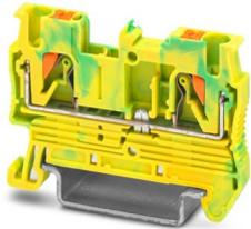
Morsetti comp. per conduttori terra, numero di connessioni: 2, tipo di connessione: Connessione Push-in, sezione: 0,14 mm<sup>2</sup> - 4 mm<sup>2</sup>, tipo di montaggio: NS 35/7,5, NS 35/15, colore: giallo-verde
