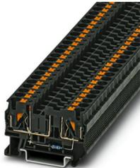
Morsetto portafusibili, tipo di fusibile: Piatta, tipo fusibile: ISO 8820-3 tipo F (miniatura), tensione nominale: 24 V DC, corrente nominale: 10 A, tipo di connessione: Connessione Push-in, Sezione di dimensionamento: 4 mm<sup>2</sup>, sezione: 0,2 mm<sup>2</sup>- 6 mm<sup>2</sup>, tipo di montaggio: NS 35/7,5, NS 35/15, colore: nero
