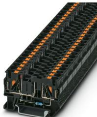
Morsetto portafusibili, tipo di fusibile: Piatta, tipo fusibile: ISO 8820-3 tipo F (miniatura), tensione nominale: 12 V DC, corrente nominale: 10 A, tipo di connessione: Connessione Push-in, Sezione di dimensionamento: 4 mm<sup>2</sup>, sezione: 0,2 mm<sup>2</sup>- 6 mm<sup>2</sup>, tipo di montaggio: NS 35/7,5, NS 35/15, colore: nero
