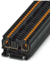
Morsetto portafusibili, tipo di fusibile: Piatta, tipo fusibile: ISO 8820-3 tipo F (miniatura), tensione nominale: 400 V, corrente nominale: 10 A, tipo di connessione: Connessione Push-in, Sezione di dimensionamento: 4 mm<sup>2</sup>, sezione: 0,2 mm<sup>2</sup>- 6 mm<sup>2</sup>, tipo di montaggio: NS 35/7,5, NS 35/15, colore: nero
