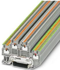
Morsetto a più piani, tensione nominale: 500 V, corrente nominale: 16 A, tipo di connessione: Connessione Push-in, 1. e 2. piano, Sezione di dimensionamento: 1,5 mm<sup>2</sup>, sezione: 0,14 mm<sup>2</sup> - 1,5 mm<sup>2</sup>, tipo di montaggio: NS 35/7,5, NS 35/15, colore: grigio
