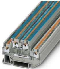
Morsetto a due piani, tensione nominale: 500 V, corrente nominale: 16 A, tipo di connessione: Connessione Push-in, 1. e 2. piano, Sezione di dimensionamento: 1,5 mm<sup>2</sup>, sezione: 0,14 mm<sup>2</sup> - 1,5 mm<sup>2</sup>, tipo di montaggio: NS 35/7,5, NS 35/15, colore: grigio
