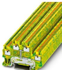
Morsetto a due piani per conduttori di terra, numero di connessioni: 4, tipo di connessione: Connessione Push-in, 1. e 2. piano, sezione: 0,14 mm<sup>2</sup> - 1,5 mm<sup>2</sup>, tipo di montaggio: NS 35/7,5, NS 35/15, colore: giallo-verde
