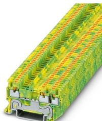
Morsetti comp. per conduttori terra, numero di connessioni: 3, tipo di connessione: Connessione Push-in, 1. piano, sezione:  $0,14 \text{ mm}^2$  -  $1,5 \text{ mm}^2$ , tipo di montaggio: NS 35/7,5, NS 35/15, colore: giallo-verde
