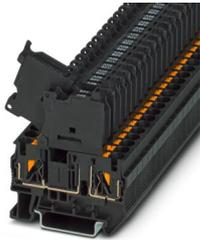
Morsetto portafusibili, tipo di fusibile: Vetro / ceramica / ..., tipo fusibile: G / 5 x 20, tensione nominale: 60 V, corrente nominale: 6,3 A, numero poli: 1, tipo di connessione: Connessione Push-in, Sezione di dimensionamento: 4 mm<sup>2</sup>, sezione: 0,2 mm<sup>2</sup>- 6 mm<sup>2</sup>, tipo di montaggio: NS 35/7,5, NS 35/15, colore: nero
