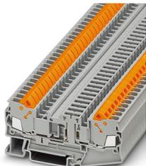
Morsetto sezionatore, Corrente e tensione sono determinate dalla spina impiegata., tensione nominale: 500 V, corrente nominale: 20 A, 1. piano, tipo di connessione: Connessione rapida, Sezione di dimensionamento: 2,5 mm<sup>2</sup>, sezione: 0,5 mm<sup>2</sup> - 2,5 mm<sup>2</sup>, montaggio: NS 35/7,5, NS 35/15, colore: grigio
