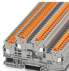
Componente morsetto componibile, La corrente massima è determinata dal diodo. Integrato: diodo 1N 4007, tensione di blocco: 1300V, corrente limite permanente: 0,5A., con diodo integrato, corrente nominale: 0,5 A, tipo di connessione: Connessione rapida, 1. e 2. piano, Sezione di dimensionamento: 1,5 mm<sup>2</sup>, sezione: 0,25 mm<sup>2</sup> - 1,5 mm<sup>2</sup>, tipo di montaggio: NS 35/7,5, NS 35/15, colore: grigio
