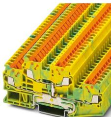
Morsetto a due piani per conduttori di terra, numero di connessioni: 4, tipo di connessione: Connessione rapida, 1. e 2. piano, sezione: 0,25 mm<sup>2</sup> - 1,5 mm<sup>2</sup>, tipo di montaggio: NS 35/7,5, NS 35/15, colore: giallo-verde
