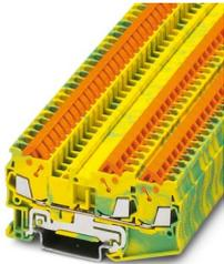
Morsetti comp. per conduttori terra, numero di connessioni: 3, tipo di connessione: Connessione rapida, 1. piano, sezione: 0,25 mm<sup>2</sup> - 1,5 mm<sup>2</sup>, tipo di montaggio: NS 35/7,5, NS 35/7,5, colore: giallo-verde
