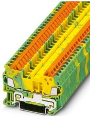
Morsetti comp. per conduttori terra, numero di connessioni: 2, tipo di connessione: Connessione rapida, 1. piano, sezione: 0,25 mm<sup>2</sup> - 1,5 mm<sup>2</sup>, tipo di montaggio: NS 35/7,5, NS 35/15, colore: giallo-verde
