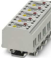
Morsetto sezionatore, tensione nominale: 24 V, corrente nominale: 41 A, tipo di connessione: Connessione a vite, Sezione di dimensionamento: 6 mm<sup>2</sup>, sezione: 0,5 mm<sup>2</sup> - 10 mm<sup>2</sup>, montaggio: NS 35/7,5, NS 35/15, NS 32, colore: grigio
