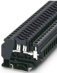
Morsetto portafusibili, tipo di fusibile: Piatta, tipo fusibile: C, tensione nominale: 250 V, corrente nominale: 30 A, numero poli: 1, tipo di connessione: Connessione a vite, 1. piano, Sezione di dimensionamento: 4 mm<sup>2</sup>, sezione: 0,2 mm<sup>2</sup>- 10 mm<sup>2</sup>, tipo di montaggio: NS 35/7,5, NS 35/15, NS 32, colore: nero
