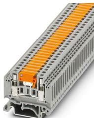
Morsetto con sezionatore a coltello, con viti per prese di prova per l'alloggiamento di spine di prova, tensione nominale: 400 V, corrente nominale: 16 A, 1. piano, tipo di connessione: Connessione a vite, Sezione di dimensionamento: 2,5 mm<sup>2</sup>, sezione: 0,2 mm<sup>2</sup> - 4 mm<sup>2</sup>, montaggio: NS 35/7,5, NS 35/15, NS 32, colore: grigio
