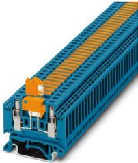
Morsetto con sezionatore a coltello, con viti per prese di prova per l'alloggiamento di spine di prova, tensione nominale: 400 V, corrente nominale: 16 A, 1. piano, tipo di connessione: Connessione a vite, Sezione di dimensionamento: 2,5 mm<sup>2</sup>, sezione: 0,2 mm<sup>2</sup> - 4 mm<sup>2</sup>, montaggio: NS 35/7,5, NS 35/15, NS 32, colore: blu
