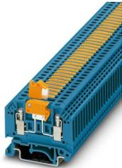
Morsetto con sezionatore a coltello, tensione nominale: 400 V, corrente nominale: 16 A, tipo di connessione: Connessione a vite, Sezione di dimensionamento: 2,5 mm<sup>2</sup>, sezione: 0,2 mm<sup>2</sup> - 4 mm<sup>2</sup>, montaggio: NS 35/7,5, NS 35/15, NS 32, colore: blu
