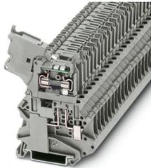
Morsetto portafusibili, tipo di fusibile: Vetro / ceramica / ..., tipo fusibile: G / 5 x 20, tensione nominale: 24 V, corrente nominale: 6,3 A, numero poli: 1, tipo di connessione: Connessione a vite, Sezione di dimensionamento: 4 mm<sup>2</sup>, sezione: 0,14 mm<sup>2</sup>- 6 mm<sup>2</sup>, tipo di montaggio: NS 35/7,5, NS 35/15, colore: grigio
