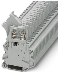
Morsetto portafusibili, tipo di fusibile: Vetro / ceramica / ..., tipo fusibile: G / 5 x 20, tensione nominale: 500 V, corrente nominale: 6,3 A, tipo di connessione: Connessione a vite, Sezione di dimensionamento: 4 mm<sup>2</sup>, sezione: 0,14 mm<sup>2</sup>- 6 mm<sup>2</sup>, tipo di montaggio: NS 35/7,5, NS 35/15, colore: grigio
