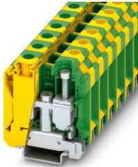
Morsetti comp. per conduttori terra, numero di connessioni: 2, tipo di connessione: Connessione a vite, Sezione di dimensionamento: 35 mm<sup>2</sup>, sezione: 10 mm<sup>2</sup> - 35 mm<sup>2</sup>, tipo di fissaggio: Piedino PE con vite di fissaggio M5, tipo di montaggio: NS 35/7,5, NS 35/15, colore: giallo-verde
