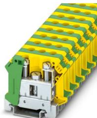
Morsetto per conduttore di terra per installazione, Connessione a vite, Sezione di dimensionamento: 35 mm<sup>2</sup>, sezione: 0,75 mm<sup>2</sup> - 35 mm<sup>2</sup>, tipo di montaggio: NS 35/7,5, NS 35/15, colore: giallo-verde
