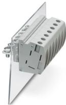
Morsetto d'esecuzione, tipo di connessione: Connessione a vite con gabbia, Attacco capocorda, numero poli: 1, corrente di carico: 101 A, sezione: 6 mm<sup>2</sup> - 35 mm<sup>2</sup>, direzione di connessione del conduttore alla direzione di inserzione: 0 °, larghezza: 15,1 mm, colore: grigio
