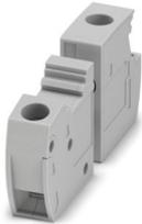
Morsetto d'esecuzione, tipo di connessione: Connessione a vite con gabbia, Connessione a vite con gabbia, numero poli: 1, corrente di carico: 32 A, sezione: 0,2 mm<sup>2</sup> - 6 mm<sup>2</sup>, direzione di connessione del conduttore alla direzione di inserzione: 0 °, larghezza: 8,1 mm, colore: grigio
