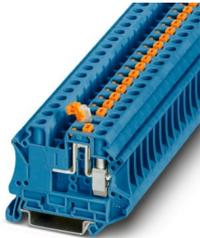
Morsetto con sezionatore a coltello, con viti per prese di prova per l'alloggiamento di spine di prova, tensione nominale: 500 V, Corrente continua termica  $I_{th}$ : 20 A, tipo di connessione: Connessione a vite, Sezione di dimensionamento: 6 mm<sup>2</sup>, sezione: 0,2 mm<sup>2</sup> - 10 mm<sup>2</sup>, montaggio: NS 35/7,5, NS 35/15, colore: blu
