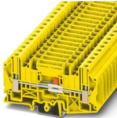
Morsetto sezionatore, tensione nominale: 1000 V, corrente nominale: 41 A, tipo di connessione: Connessione a vite, 1. piano, Sezione di dimensionamento: 6 mm<sup>2</sup>, sezione: 0,2 mm<sup>2</sup> - 10 mm<sup>2</sup>, tipo di montaggio: NS 35/7,5, NS 35/15, NS 32, colore: giallo
