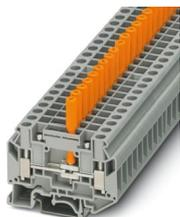
Morsetto sezionatore, con vite zigrinata, per il comando manuale della squadretta sezionatrice, tensione nominale: 500 V, corrente nominale: 41 A, tipo di connessione: Connessione a vite, 1. piano, Sezione di dimensionamento: 6 mm<sup>2</sup>, sezione: 0,5 mm<sup>2</sup> - 10 mm<sup>2</sup>, tipo di montaggio: NS 35/7,5, NS 35/15, NS 32, colore: grigio
