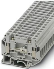
Morsetto sezionatore, tensione nominale: 500 V, corrente nominale: 41 A, tipo di connessione: Connessione a vite, 1. piano, Sezione di dimensionamento: 6 mm<sup>2</sup>, sezione: 0,5 mm<sup>2</sup> - 10 mm<sup>2</sup>, tipo di montaggio: NS 35/7,5, NS 35/15, NS 32, colore: grigio
