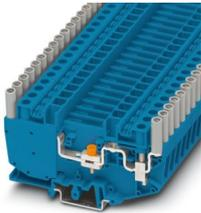
Morsetto sezionatore per conv. misura, con blocchetto scorrevole, tensione nominale: 500 V, corrente nominale: 41 A, tipo di connessione: Connessione a vite, 1. piano, Sezione di dimensionamento: 6 mm<sup>2</sup>, sezione: 0,5 mm<sup>2</sup> - 10 mm<sup>2</sup>, tipo di montaggio: NS 35/7,5, NS 35/15, NS 32, colore: blu
