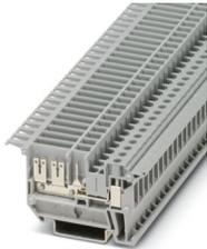
Morsetto passante, Corrente e tensione sono determinate dalla spina impiegata., tensione nominale: 800 V, corrente nominale: 23 A, 1. piano, collegamento a destra, tipo di connessione: Connessione a vite, Sezione di dimensionamento: 2,5 mm<sup>2</sup>, sezione: 0,2 mm<sup>2</sup> - 4 mm<sup>2</sup>, montaggio: NS 35/7,5, NS 35/15, colore: grigio
