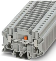
Morsetto sezionatore per conv. misura, tensione nominale: 500 V, corrente nominale: 41 A, tipo di connessione: Connessione a vite con supporto a molla, 1. piano, Sezione di dimensionamento: 6 mm<sup>2</sup>, sezione: 0,2 mm<sup>2</sup> - 10 mm<sup>2</sup>, tipo di montaggio: NS 35/7,5, NS 35/15, NS 32, colore: grigio
