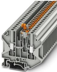
Morsetto con sezionatore a coltello, con viti per prese di prova per l'alloggiamento di spine di prova, tensione nominale: 500 V, corrente nominale: 20 A, 1. piano, tipo di connessione: Connessione a vite con supporto a molla, Sezione di dimensionamento: 4 mm<sup>2</sup>, sezione: 0,2 mm<sup>2</sup> - 6 mm<sup>2</sup>, montaggio: NS 35/7,5, NS 35/15, NS 32, colore: grigio
