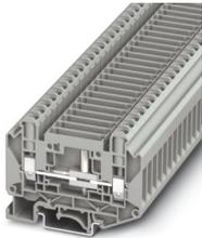
Morsetto sezionatore per conv. misura, tensione nominale: 1000 V, corrente nominale: 41 A, tipo di connessione: Connessione a vite, 1. piano, Sezione di dimensionamento: 6 mm<sup>2</sup>, sezione: 0,2 mm<sup>2</sup> - 10 mm<sup>2</sup>, tipo di montaggio: NS 35/7,5, NS 35/15, NS 32, colore: grigio
