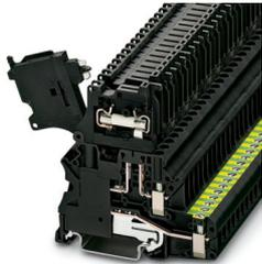
Morsetto portafusibili, tipo di fusibile: Vetro / ceramica / ..., tipo fusibile: G / 5 x 20, tensione nominale: 250 V, corrente nominale: 6,3 A, tipo di connessione: Connessione a vite, Sezione di dimensionamento: 4 mm<sup>2</sup>, sezione: 0,14 mm<sup>2</sup>- 6 mm<sup>2</sup>, tipo di montaggio: NS 35/7,5, NS 35/15, colore: nero
