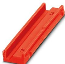
Profilo di codifica, per blocchi UTWE 6-2 e UTRE 6-2, esecuzione: triangolare, profondità: 4,3 mm, larghezza: 10,7 mm, altezza: 44,7 mm, colore: rosso, tipo di montaggio: Inserire a scatto
