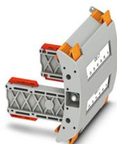
Connettore cieco, Codifica VDE tipo E7, passo: 8,2 mm, larghezza: 71 mm, altezza: 81 mm, numero poli: 7, colore: grigio, tipo di montaggio: Innesto nella presa base
