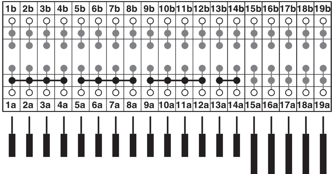
Lo schema elettrico mostra il connettore a innesto di prova con spina di prova inserita
