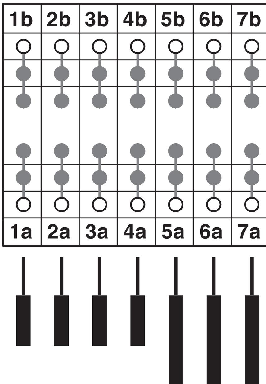
Lo schema elettrico mostra il connettore a innesto di prova con spina di prova inserita
