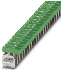
Morsetto di collegamento, tensione nominale: 300 V, corrente nominale: 41 A, tipo di connessione: Connessione a vite, Sezione di dimensionamento: 4 mm<sup>2</sup>, sezione: 0,5 mm<sup>2</sup> - 6 mm<sup>2</sup>, montaggio: Barra colletttrice N, colore: verde
