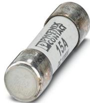
Fusibile, per l'industria fotovoltaica secondo UL 2579, tensione nominale: 1000 V, corrente nominale: 15 A, altezza: 38 mm, dimensioni: 10,3 mm, colore: bianco
