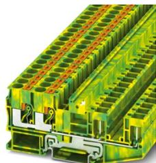
Morsetti comp. per conduttori terra, numero di connessioni: 4, tipo di connessione: Push-in / attacco connettore, sezione: 0,5 mm<sup>2</sup> - 10 mm<sup>2</sup>, tipo di montaggio: NS 35/7,5, NS 35/15, colore: giallo-verde
