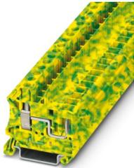
Morsetti comp. per conduttori terra, Corrente e tensione sono determinate dalla spina impiegata., numero di connessioni: 2, tipo di connessione: Connessione a vite/a innesto, sezione: 0,2 mm<sup>2</sup> - 10 mm<sup>2</sup>, tipo di montaggio: NS 35/7,5, NS 35/15, colore: giallo-verde
