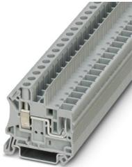
Morsetto passante, tensione nominale: 1000 V, corrente nominale: 41 A, numero di connessioni: 2, tipo di connessione: Connessione a vite/a innesto, Sezione di dimensionamento: 6 mm<sup>2</sup>, sezione: 0,2 mm<sup>2</sup> - 10 mm<sup>2</sup>, tipo di montaggio: NS 35/7,5, NS 35/15, colore: grigio
