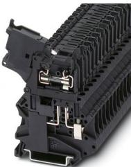
Morsetto portafusibili, tipo di fusibile: Vetro / ceramica / ..., tipo fusibile: G / 5 x 20, tensione nominale: 500 V, corrente nominale: 6,3 A, tipo di connessione: Connessione a vite, Sezione di dimensionamento: 4 mm<sup>2</sup>, sezione: 0,14 mm<sup>2</sup>- 6 mm<sup>2</sup>, tipo di montaggio: NS 35/7,5, NS 35/15, colore: blu
