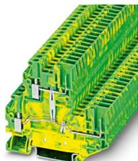
Morsetto a due piani per conduttori di terra, Corrente e tensione sono determinate dalla spina impiegata., tipo di connessione: Connessione a vite/a innesto, sezione:  $0,14 \text{ mm}^2 - 4 \text{ mm}^2$ , tipo di montaggio: NS 35/7,5, NS 35/15, colore: giallo-verde
