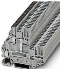
Morsetto a due piani, Corrente e tensione sono determinate dalla spina impiegata., con ripartitore di potenziale, tensione nominale: 500 V, corrente nominale: 24 A, tipo di connessione: Connessione a vite/a innesto, Sezione di dimensionamento: 2,5 mm<sup>2</sup>, sezione: 0,14 mm<sup>2</sup> - 4 mm<sup>2</sup>, tipo di montaggio: NS 35/7,5, NS 35/15, colore: grigio
