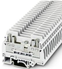
Morsetto sezionatore, tensione nominale: 400 V, corrente nominale: 41 A, tipo di connessione: Connessione a vite, 1. piano, Sezione di dimensionamento: 6 mm<sup>2</sup>, sezione: 0,5 mm<sup>2</sup> - 10 mm<sup>2</sup>, tipo di montaggio: NS 35/7,5, NS 35/15, NS 32, colore: bianco
