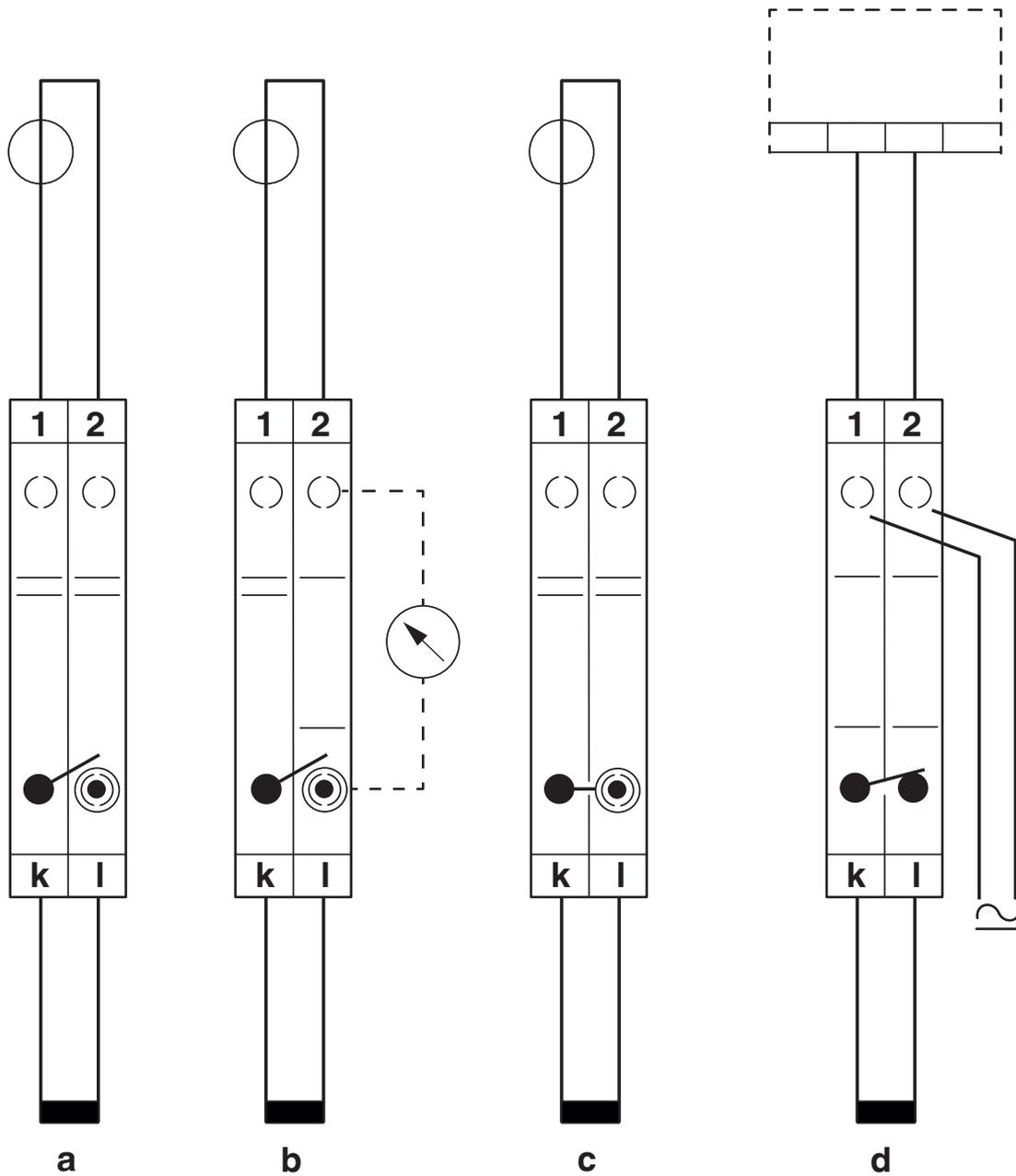
Collegamento di prova convertitore di corrente semplice
